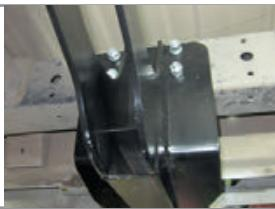
**ШАГ 3.** Закрепите кронштейн центральный на круглой балке с помощью кронштейна гнутоого, соединив обе детали с помощью двух болтов M10x1,25x40 через шайбы 10 и гроверные 10, гайками M10x1,25, и болтов M12x1,25x45 через шайбы 12 и шайбы 12 гроверные, гайками M12x1,25 снизу, как показано на схеме. Соединения не затягивать.
